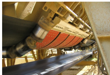
Zementfabrik, 800 T/heure. Band 1200 (5 aufgehängene Schnallen)
