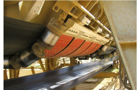
Cementerie, 800 T/h, nastro da 1200 (5 cinghie sospese)
